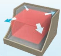
例えば 断熱材の厚みを減らすことで容積が拡大
